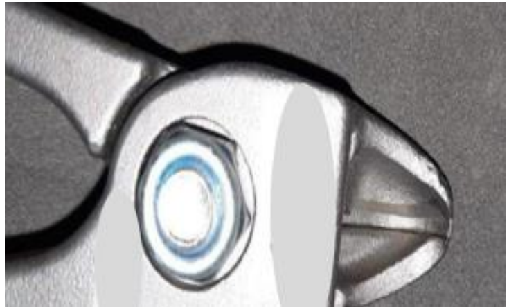
Figuur 3: Die knipper moet plat op die kelkblare rus, maar dit nie raaksny nie, slegs die stingel. Die lemme oorvleuel wanneer die snit gemaak word, wat die risiko vir skeuring van die stingel verminder.
