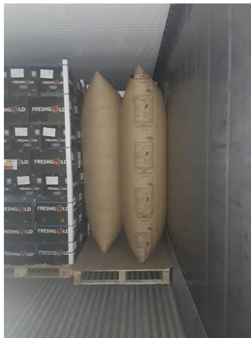
Figuur 3: Voorbeelde van 'n houtbasis met geriffelde kartonne en lugsakke. Let daarop dat een stuk onbeskadigde geriffelde karton bo-op die paletbasis is.
