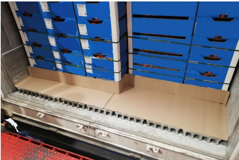
Figuur 1: 'n Korrek-geïnstalleerde void plug . Let wel: (1) Die void plug aan die einde van die T-staaf vloer. (2) Alle openinge langs die vloer en paletbasisse is toegemaak. (3) Daar is geen kans dat die void plug tydens die vaart sal beweeg of opvou nie.
